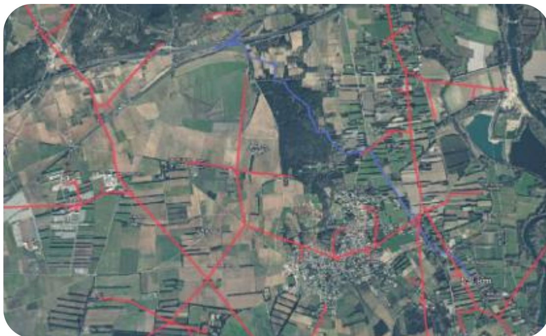
Figure 10 - Possibilités de raccordement plein réseau à 5,31 km pour la zone ouest – Source : Enedis
